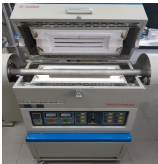
Рисунок 14 – Общий вид трубчатой вращающейся печи
